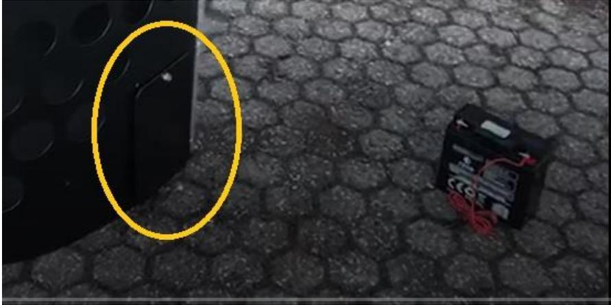
Hinter der Abdeckung befindet sich das Anschlusskabel. Dieses Kabel muss mit der Batterie verbunden werden. Einfach die beiden Stecker zusammenstecken.
